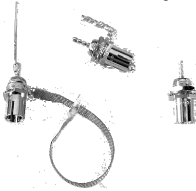
Bild 12: Zur Messung der Wellenformen in Schaltnetzteilen sollten nur einlötbare Tastkopfadapter zum Einsatz kommen
